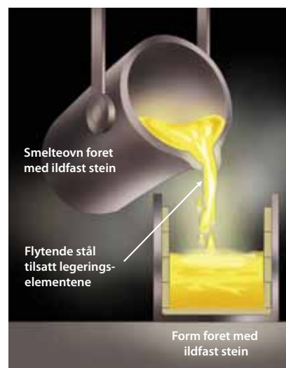
Støping av valseblokker. Hver blokk kan veie flere tonn.
